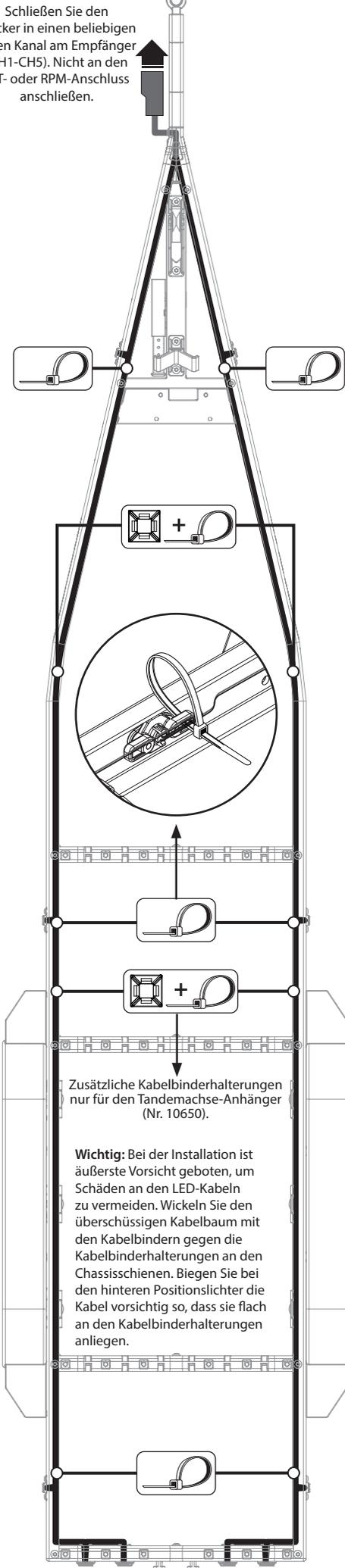
Zusätzliche Kabelbinderhalterungen nur für den Tandemachse-Anhänger (Nr. 10650).
