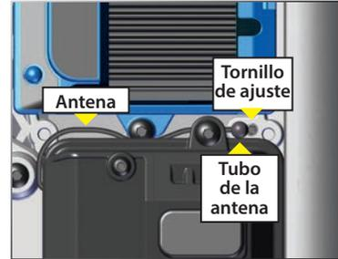
**!** Asegúrese de que la antena del receptor del modelo esté bien instalada antes de hacer funcionar su modelo. *No instalar correctamente la antena del receptor reducirá considerablemente el rango de la radio y posiblemente se perderá el control.*
