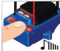
Ajustes del transmisor para el ESC del BL-2s
