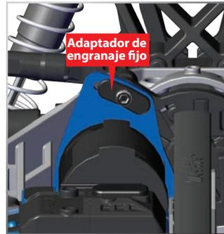
Para configurar la rueda dentada, afloje el tornillo del motor. Corte una tira angosta de papel de cuaderno y colóquela en la rueda dentada. Deslice el motor y el engranaje de piñón recto. Vuelva a ajustar los tornillos del motor y luego retire la tira de papel. Usted podrá colocar una nueva tira de papel entre los engranajes sin causar agarrotamiento.
