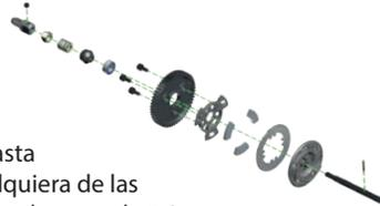
restablecer los valores de tolerancia de fábrica. Los cojinetes de la palanca acodada podrán ser reemplazados con rodamientos de eje 5x8mm (pieza n.º 2728).
