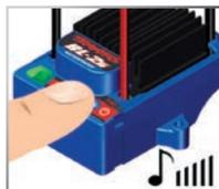
Para desactivar la detección de bajo voltaje (configuración NiMH):
