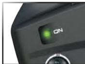
Si el led de estado parpadea en rojo, las baterías del transmisor pueden estar con poca carga, sin carga o quizá mal instaladas. Reemplace con baterías nuevas o recién cargadas. La luz indicadora de energía no indica el nivel de carga del paquete de baterías instalado en el modelo. Consulte la sección de resolución de problemas de la página 31 para obtener más información sobre los códigos del led de estado del transmisor.
