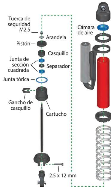
**Note: Los orificios de los pistones delantero y trasero tienen diferentes tamaños. Asegúrese de usar los pistones correctos para los amortiguadores delantero y trasero durante el desmontaje o el ensamblaje (consulte la columna lateral para obtener más información).**
