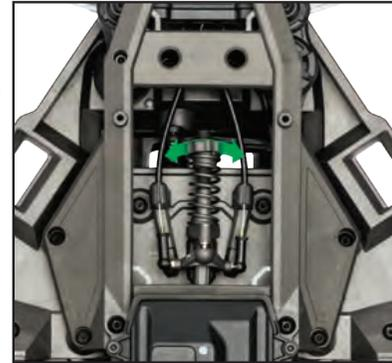
El ajuste de precarga estándar en el resorte está a 7 mm del extremo de la varilla roscada. Se debe seguir un rango recomendado de 3-10 mm para el servo de frenado instalado de fábrica. Para un frenado más agresivo (ajuste de precarga de más de 10 mm), se recomienda actualizar el servo (servos disponibles: piezas n.º 2250, 2255, 2275, 2280).
