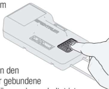
**WICHTIG:** Der Empfänger wechselt nicht in den Bindungsmodus, wenn irgendwelche zuvor gebundene Sender eingeschaltet sind, bevor der Empfänger eingeschaltet ist.
