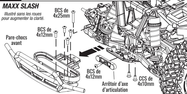
**Fig 2 Retrait du arrêtoir d'axe d'articulation arrière**
