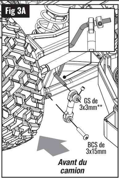
**Fig 4 Installation de la barre antiroulis arrière**
