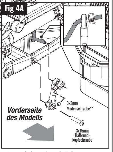
\*Hinweis: Drehen Sie die 3 x 6 mm Flachkopfschrauben in die Löcher, bis sie den Stabilisator berühren und lösen Sie sie dann wieder leicht. Der Stabilisator muss frei schwenkbar sein.
