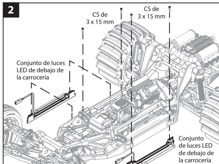
**2** Instale los conjuntos de luces LED de debajo de la carrocería (izquierda y derecha) en el chasis utilizando el tornillo de cabeza avellanada de 3 x 15 mm retirado en el paso 1.
