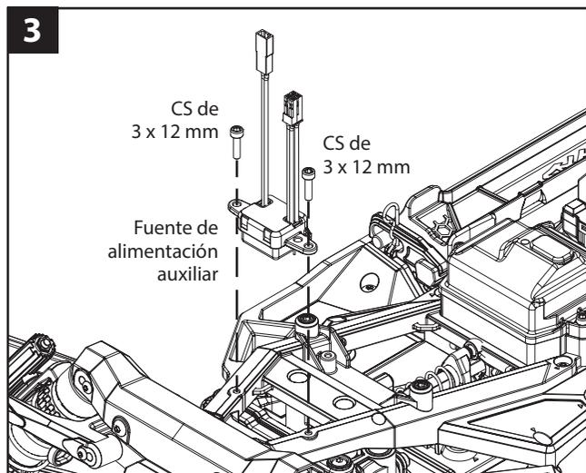
**3** Instale la fuente de alimentación auxiliar de 3 voltios incluida en la abrazadera superior delantera del chasis con el tornillo de cabeza avellanada (2) de 3 x 12 mm incluido, tal como se muestra.
