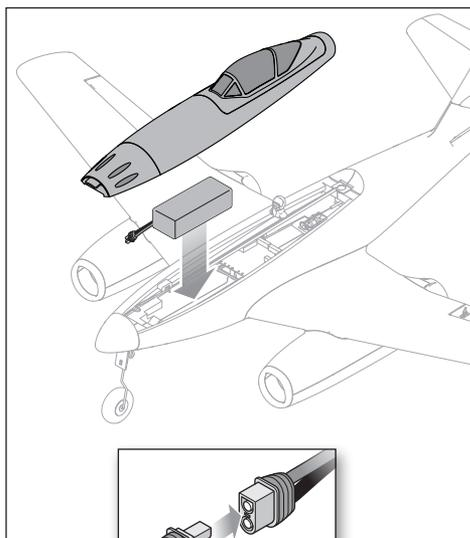
**⚠ ATTENZIONE:** quando non si vola, scollegare sempre la batteria LiPo dall'ESC per non alimentare il motore. L'ESC non ha un interruttore per armarlo e quindi risponde subito ad ogni comando del trasmettitore.
