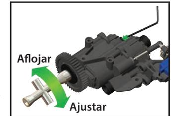
Para restablecer los ajustes de fábrica, utilice la llave cruz incluida para girar la tuerca de ajuste hasta que las cuatro arandelas elásticas estén planas; luego, apriete la tuerca 1/16 de giro adicional (o hasta que el embrague deslizante no permita que el engranaje recto se deslice durante el funcionamiento normal).
