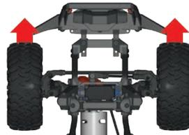
7. Maneje con suavidad el gatillo de velocidad para asegurarse de tener marcha adelante y marcha atrás y de que el motor se detiene cuando el gatillo de velocidad está en posición neutral. **ADVERTENCIA: No aplique aceleración total en marcha adelante o atrás mientras el modelo se encuentre elevado.**
