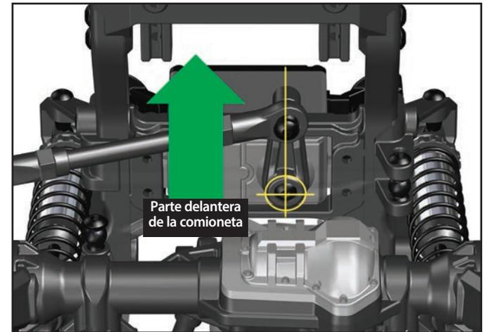
Si está utilizando servos de recambio, es importante usar bocinas de servos diseñadas para TRX-4 Sport. Las bocinas del servo deben medir 22 mm desde el orificio de montaje del varillaje de la dirección hasta el orificio de montaje del servo.
