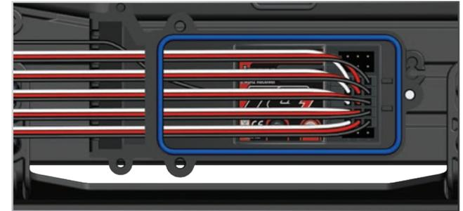
4. Aplique una gotita de grasa de silicona (n.º de pieza 1647 de Traxxas) en la sujeción de cables.
